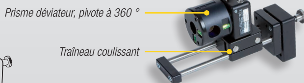
A. Grâce au prisme déviateur rotatif, vous pouvez atteindre le détecteur quasiment n'importe où sur la machine. B. Grâce au traîneau, l'alignement du rayon avec le détecteur se fait rapidement et simplement.
