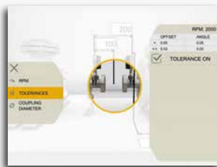
Vérification de la tolérance
